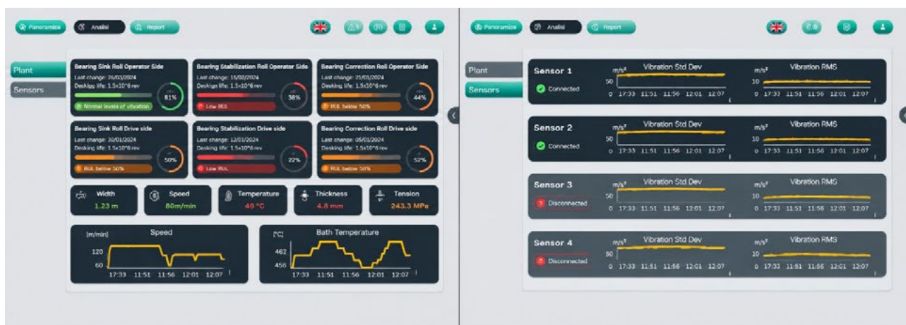
Fig.12 - Dashboard di supporto alle decisioni con i dati sull'impianto (sinistra) e sui sensori di vibrazione (destra) / Decision-support dashboard with information about the plant (left) and the vibration sensors (right).
