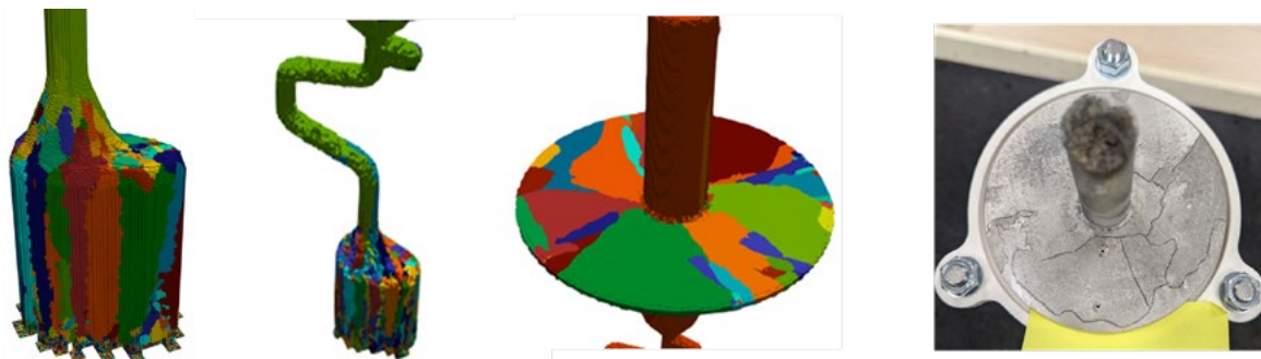
Fig. 7 - Details of the base, the selector and the plate with parasitic grains (compared to experimental case) / Dettagli della base, del selettore e del piatto con i grani parassiti (paragonato ad un caso sperimentale).
