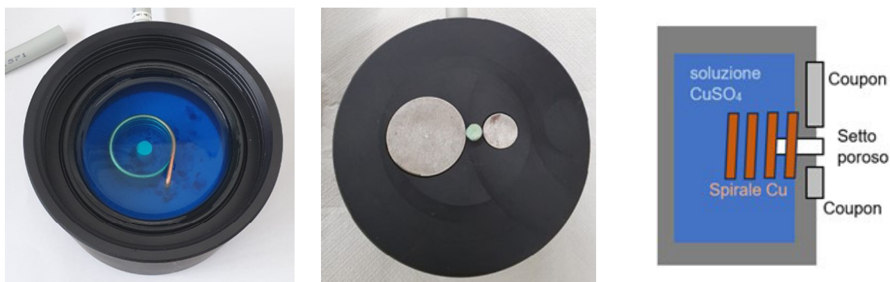
Fig. 1 - Immagini del prototipo della nuova sonda / Images and scheme of the prototype of the new probe.
