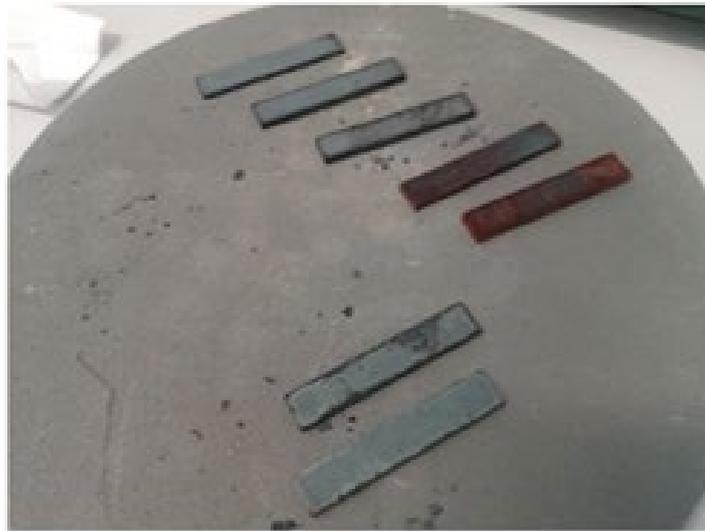
**Fig.2** - Campioni dopo vari trattamenti termici di stress relieving / Samples after various stress relieving heat treatments
