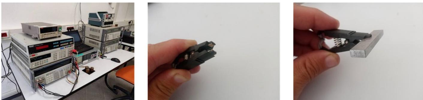
**Fig.8** - Misura della resistenza elettrica / Measurement of electrical resistance
