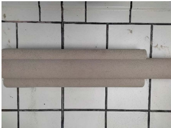
Fig.5-6 - Anime prodotte con INOL1 + INOP2 / Cores produced with INOL1 + INOP2.
