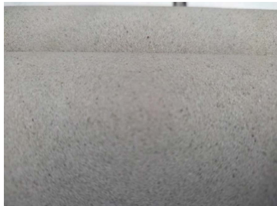
Fig.5-6 - Anime prodotte con INOL1 + INOP2 / Cores produced with INOL1 + INOP2.
