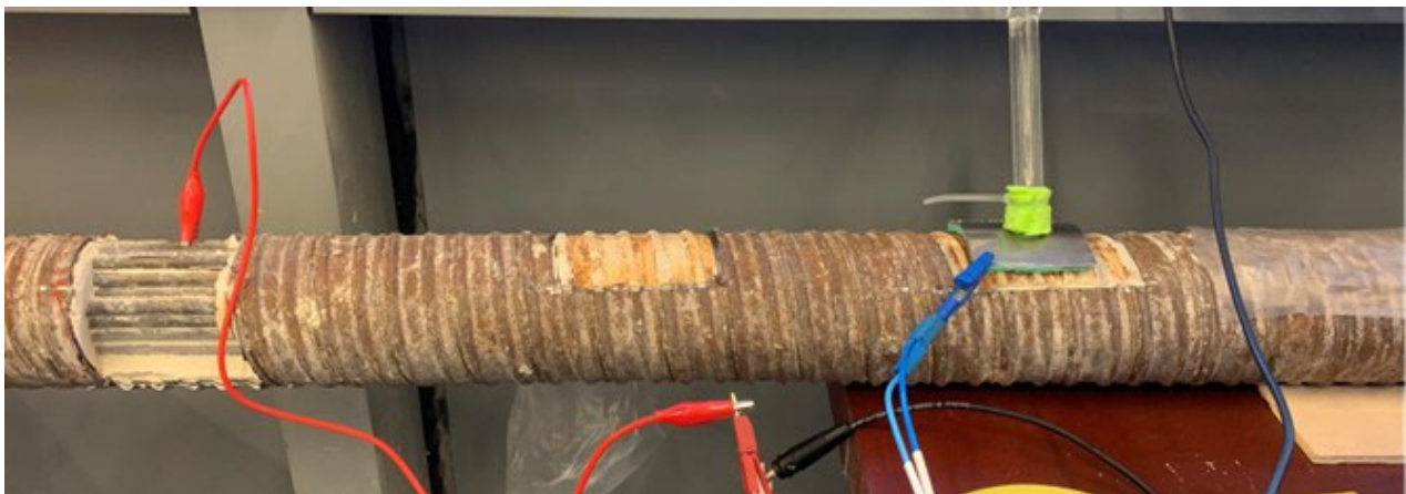
Fig.2 - Set-up di misura della velocità di corrosione. / Corrosion rate measurement set up.
