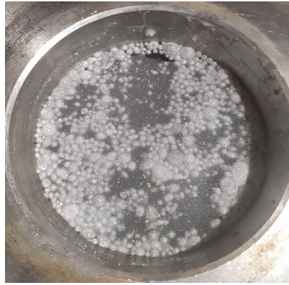
Fig.7 - Lato interno del reattore, immediatamente prima della formazione degli idrati / Internal side of the reactor, immediately before hydrates formation.
