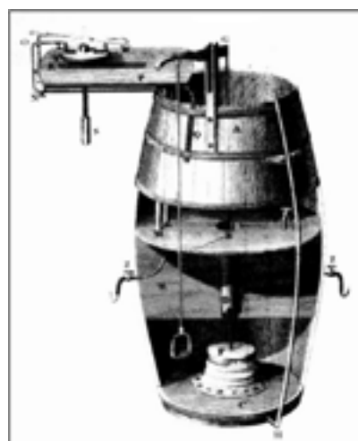
Fig.3 - Apparato di fusione ideato e costruito da R. Hare compreso di due vani fisicamente distinti per lo stoccaggio dell'idrogeno e dell'ossigeno / R. Hare melt system with two physically separated sectors for the hydrogen and oxygen storage.
