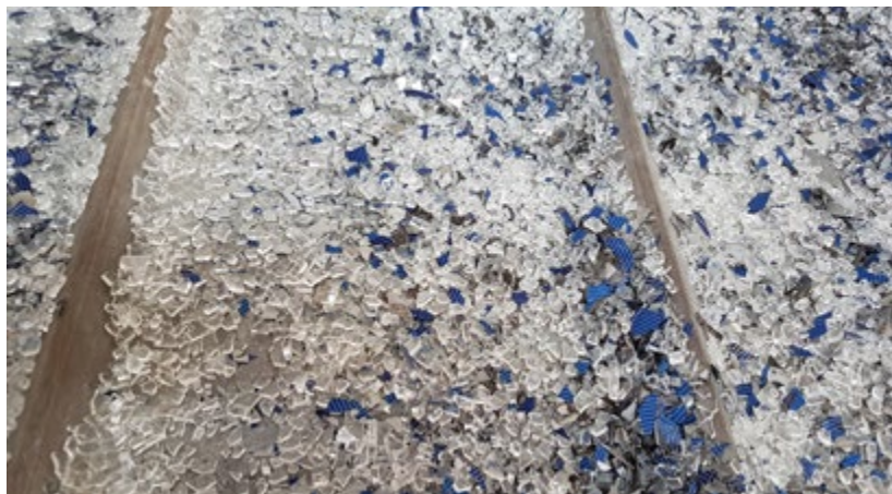
Fig.3 – PV panel after heating treatment in ReSiELP pilot plant/ Un pannello fotovoltaico dopo il trattamento termico nell'impianto pilota ReSiELP
