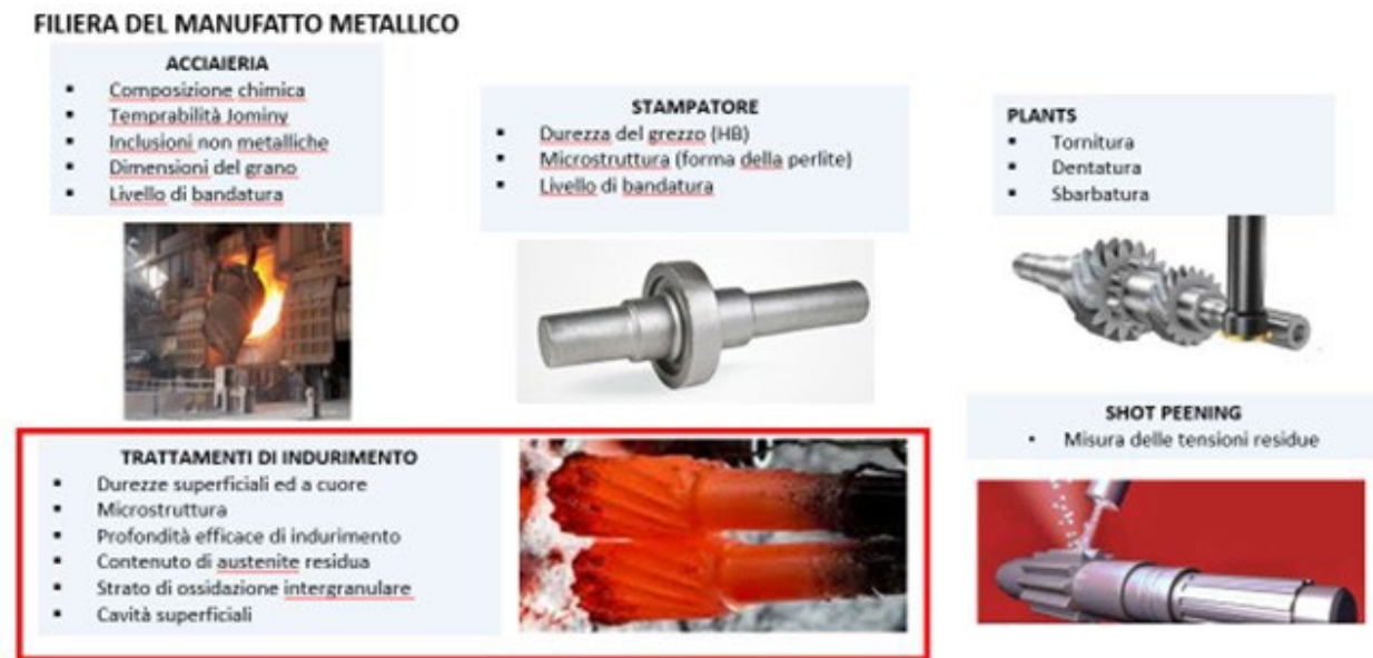
Fig.1 -Filiera di un manufatto metallico.
