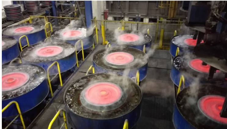
Fig.1 - RTrattamento di tempra differenziale (Rim Chilling) presso Lucchini RS.
