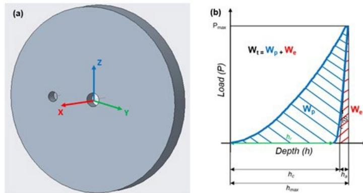
**Fig.1** – (a) Representative scheme of the specimens: building axis (z) and plane parallel to the building platform (xy), (b) Load-unload curve for the instrumented indentation technique. / (a) Schema rappresentativo dei provini: asse di costruzione (z) e piano parallelo alla piattaforma di costruzione (xy), (b) Curva di carico-scarico per la tecnica di nanoindentazione strumentata.
