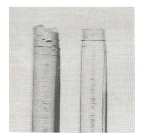
**Fig.7** - Stress corrosion cracking of a Ni Cr Mo low alloy steel in methanol (left) and ethanol (right) (10 -1 mol m -3 LiCl, 10 -1 mol m -3 H2SO4/ Tensocorrosione di un acciaio basso legato Ni Cr Mo in metanolo (sinistra) e in etanolo (destra) (10 -1 mol m -3 LiCl, 10 -1 mol m -3 H2SO4).
