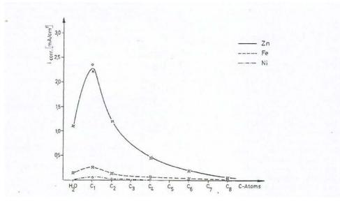
**Fig.4** - Corrosion rate of Zn, Fe and Ni in primary alcohols vs carbon number of solvent: methanol C1, ethanol C2 / Velocità di corrosione per Zn, Fe and Ni in alcoli primary, in funzione del numero di carbonio del solvente.
