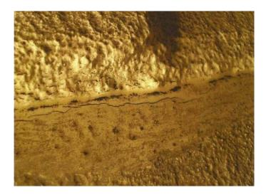
Fig.3 - Cracking on the bottom of a methanol tank / Fratture sul fondo di un serbatoio di metanolo.
