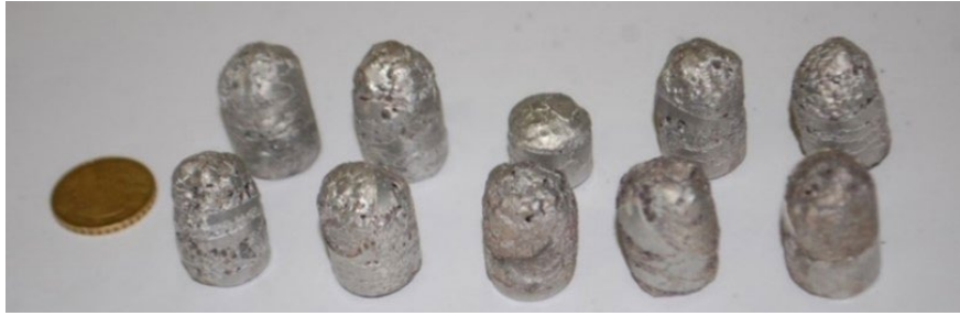
Fig.1 - Esempi di alcune schiume di Al / Examples of Al foams.
