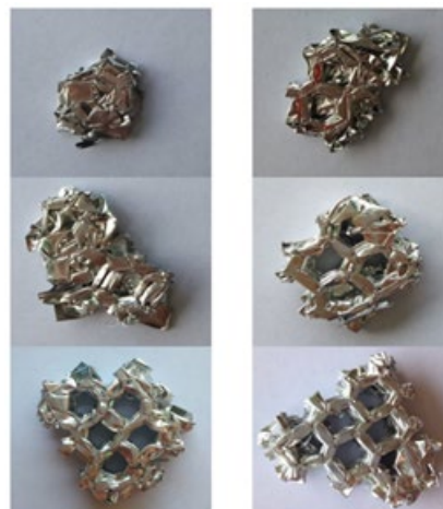
Fig.7 - Vista dall'alto delle celle esagonali dopo compressione / Top view of the hexagonal cells after compression
