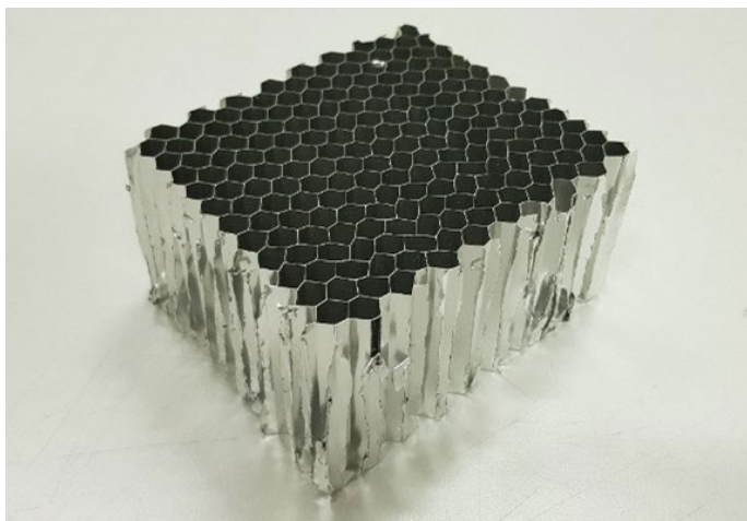
Fig.4 - Vista laterale di un provino in honeycomb / Side view of a honeycomb specimen.
