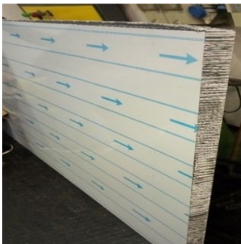
Fig.1 - Pannello e campioni con struttura a nido d'ape in alluminio / Panel and aluminum samples with honeycomb structure.
