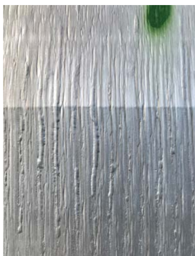
Fig.7 - Immagini di vari tipi di essudazioni su placche. / Picture of different visible sweat phenomena on the plaques.
