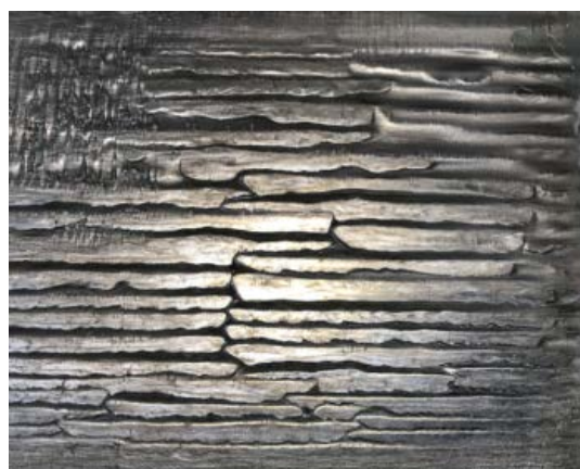
Fig.5 - Immagine di piega fredda sulla superficie di una placca in lega AA8006. / Picture of a cold shut on the surface of AA8006 plate.
