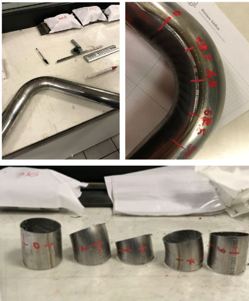
Fig.16 - Angoli di misurazione su campioni di tubo in acciaio AISI 441 (diametro 60 mm, spessore 1.2 mm e R/D=1 ) / Thickness measuring grid on the backbone of AISI 441 steel (60 mm diameter size, thickness 1.2 mm, R/D=1 ).
