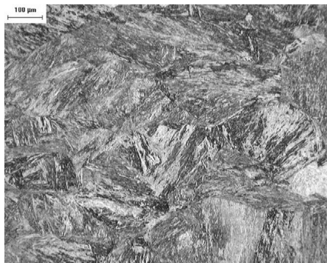
Fig.1 - Microstruttura dell'acciaio EUROFER97 ottenuta con il tradizionale processo di produzione / EUROFER97 steel microstructure obtained with the traditional production process
