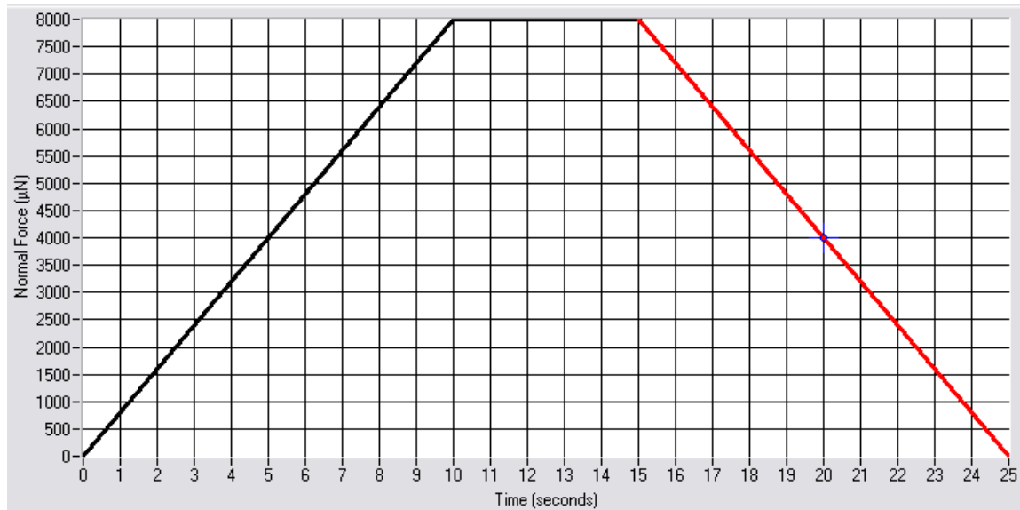
Fig.4 - Funzione di carico utilizzata per le prove di nanoindentazione / Load function used for the nanoindentation tests.
