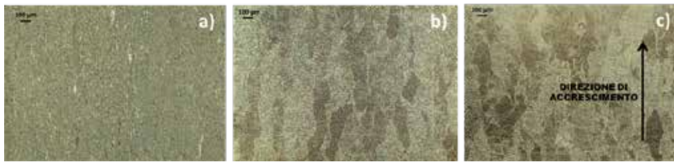
Fig.1 - Immagini acquisite mediante microscopio ottico lungo la direzione di laminazione per il campione Ti6Al4V (a) e lungo la direzione di accrescimento per i campioni LM_DMLS vergine (b) e LM_DMLS 1° riciclo (c) Fig. 1 – Optical Images acquired along the processing direction for the sample Ti6Al4V (a) and along the building direction for the virgin samples LM_DMLS (b) and LM_DMLS 1st recycling (c).
