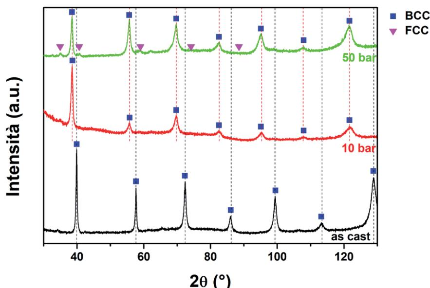
**Fig. 4** - Diffattogrammi di raggi X della lega TiV<sub>0.6</sub>Cr<sub>0.3</sub>Zr<sub>0.3</sub>NbMo dopo assorbimento di idrogeno a 10 bar (in rosso) e 50 bar (in verde). Il risultato ottenuto per il campione as cast viene riproposto per confronto (in nero).
