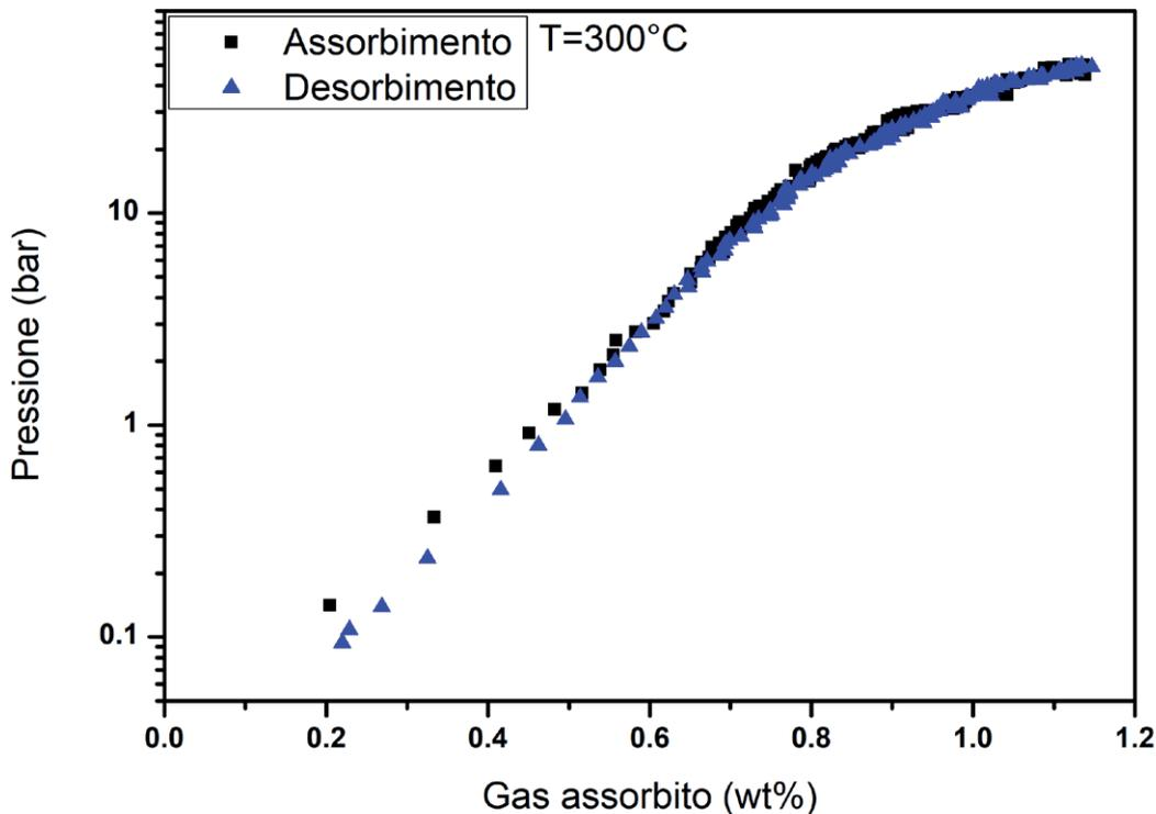
Fig. 3 - Analisi PCI a 300 °C della lega TiV0.6Cr0.3Zr0.3NbMo.
