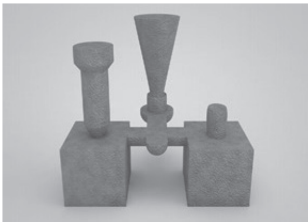
Fig.19 - Volume ridotto dell'alimentatore. Questi vantaggi nella tecnologia di alimentazione costituiscono un grande contributo alla produttività e alla competitività delle fonderie moderne.
