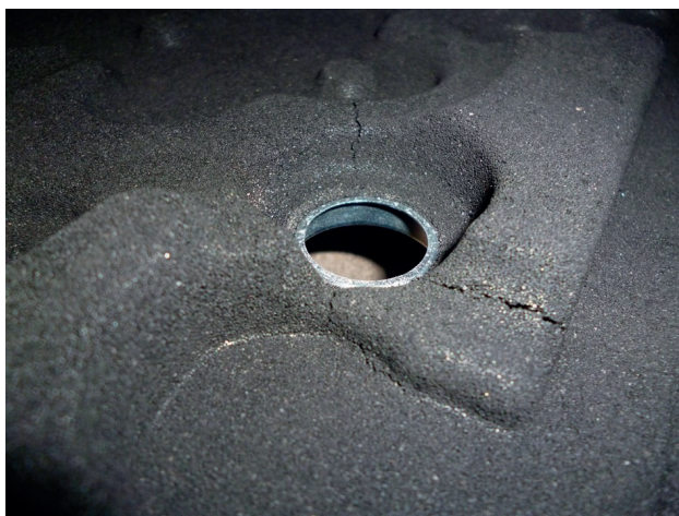
Fig. 12 - Cricche dello stampo causate dall'effetto del ritorno elastico
