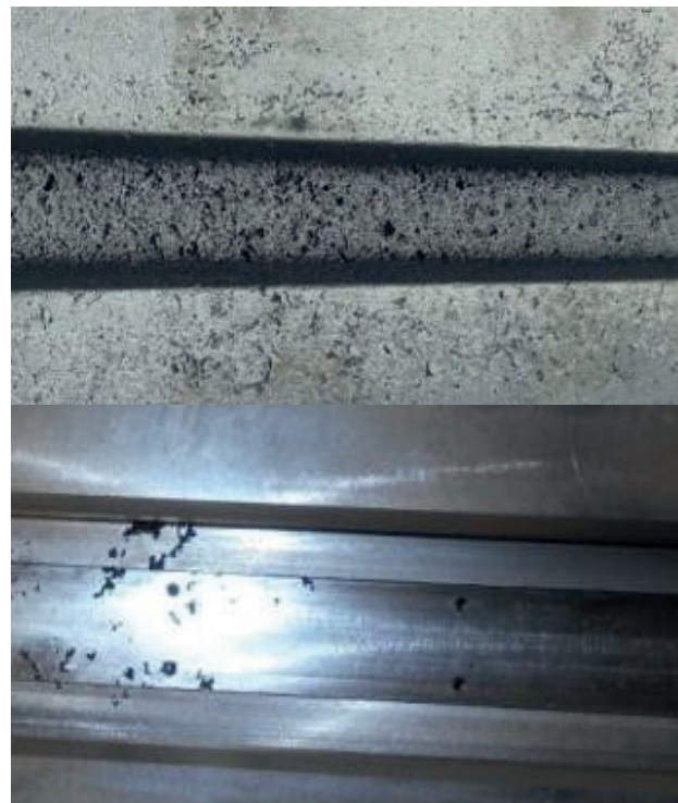
Fig. 16 - Superficie del grezzo realizzato in una fonderia italiana: grezzo dopo granigliatura (in alto) e dopo lavorazione meccanica (in basso).
