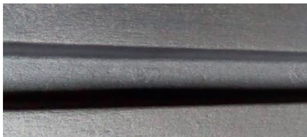
Fig. 17 - Superficie dello stesso grezzo di Fig. 16 dopo l'applicazione dell'impregnante Durosol® 9125 W20.
