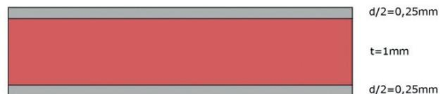
**Fig. 3** - Schema semplificato del sistema contenitore-metallo
