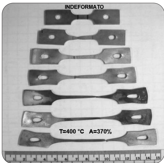
Fig. 5 Immagine dei provini in lega AZ31 dopo le prove di trazione in regime di superplasticità. Specimens of the AZ31 alloy after the superplastic tensile tests.
