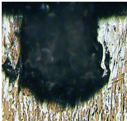
**Fig. 12** - Micrografia della sezione di un pit da bromuri su SAF 2205 solubilizzato a 1080 °C per 30 minuti (500X).
