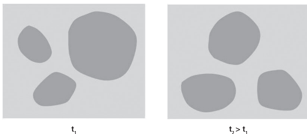
Fig. 2 - Aree anodiche e catodiche a t_1 e t_2 . Allo stato stazionario, le zone grigio scuro si muovono sulla superficie ma la loro area totale resta costante.
