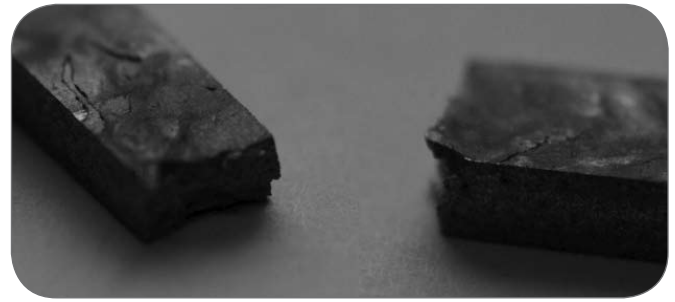
Fig. 5 Picture of test specimens with flow lines on the surface. Immagine dei campioni di prova con linee di scorrimento sulla superficie.
