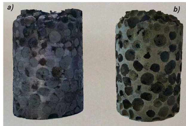
Fig. 2 - Campione di spugna dopo tornitura (a) e dopo rimozione del riempitivo (b)
