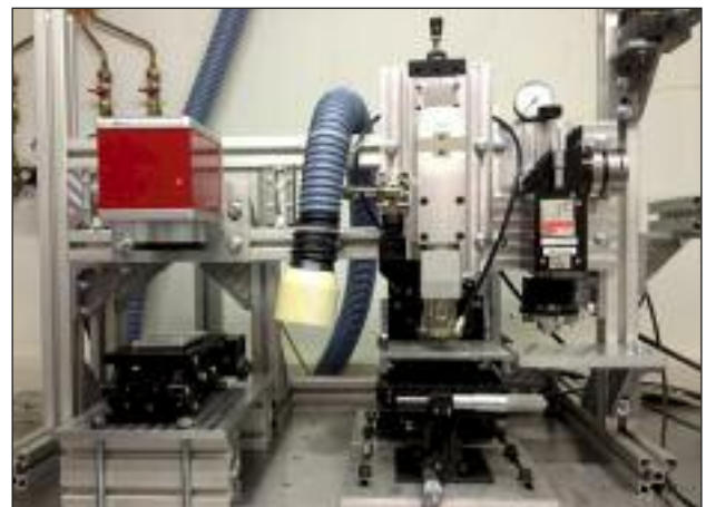
FIG. 1 Vista generale del sistema di lavorazione per microlavorazioni laser.
