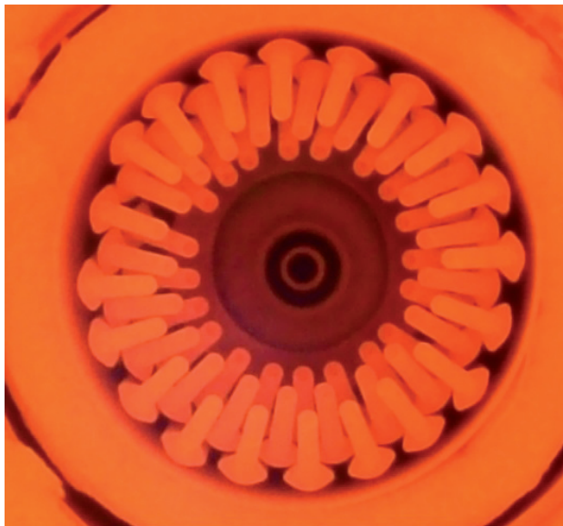
Fig. 6 - Bruciatore con recuperatore a canali suddivisi in funzionamento senza fiamma
