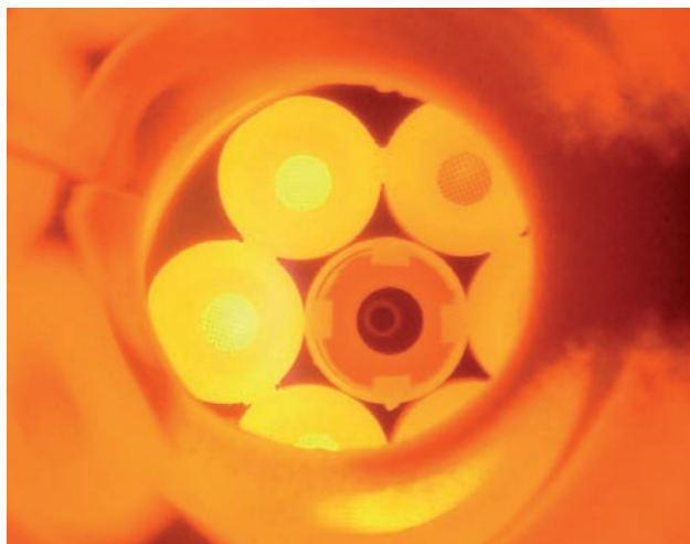
Fig. 3 - Bruciatore rigenerativo in funzionamento "senza fiamma"
