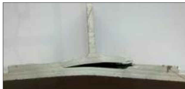
FIG. 11 Modalità di frattura del campione sottoposto a prova T-pull.
