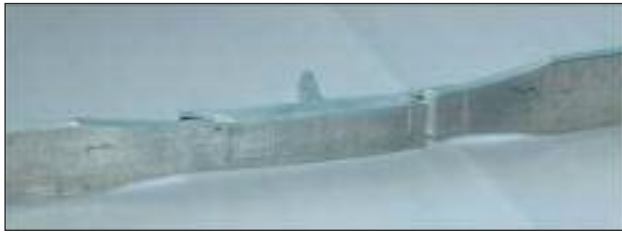
FIG. 5 Modalità di frattura in test hoop stress. Failure mode in static hoop stress test.
