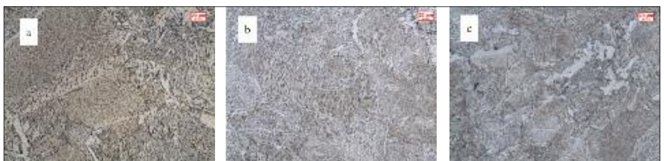
FIG. 4 Fusion zone microstructure: a) GTAW, b) PAW, c) EBW. Microstruttura della zona fusa: a) GTAW, b) PAW, c) EBW.
