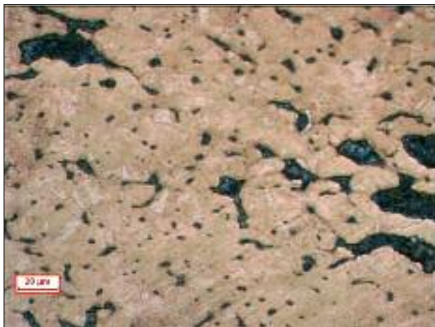
FIG. 8 Micrografia del C54 (M.O., ammonio persolfato). C54 M.O. Micrograph, after etching with ammonium persulfate.
