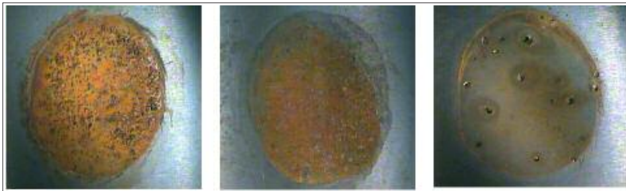
FIG. 10 Superficie dei campioni nitrocarburiati dopo polarizzazione (8x).
