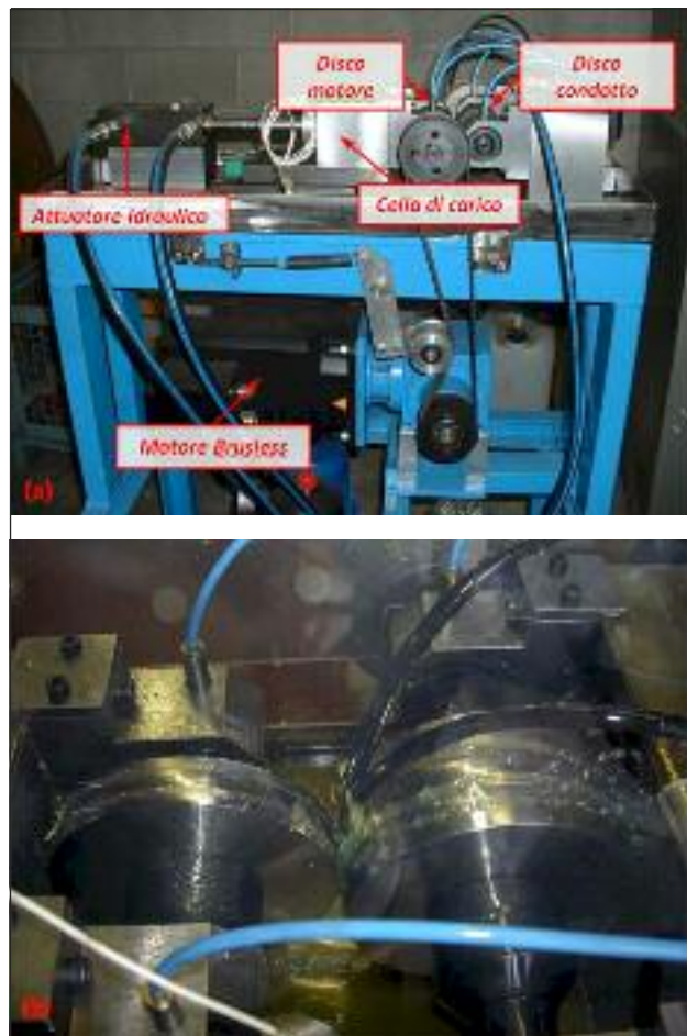
FIG. 1 Apparato sperimentale utilizzato per l'esecuzione delle prove di usura per fatica: a) Vista d'insieme b) Campione Q2 in regime di moto di rotolamento puro con lubrificazione.
