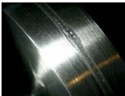
FIG. 3 Danneggiamento per pitting osservato ad occhio nudo sul campione Q2 ( 2.12 \times 10^6 cicli).
