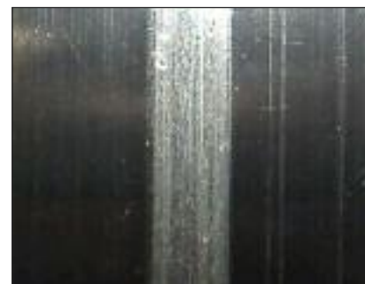
FIG. 5 Danneggiamento per pitting osservato sul campione N2 ( 3.6 \times 10^6 cicli).
