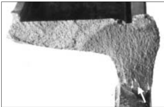
Fig. 7 – Macromorfologia della superficie di rottura fortemente ossidata del montante mozzo ruota. Si nota una zona scura verso l'innesco (freccia) e una chiara nella regione opposta.
