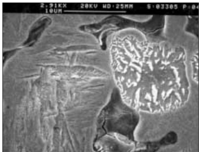
Fig. 5 e 6 – Spessori 16 mm, alta e bassa densità, SEM. Influenza della massa volumica sul tipo di struttura aciculare che si sviluppa al raffreddamento: per la massa volumica maggiore prevale la trasformazione in martensite (fig. 5), per quella inferiore in bainite inferiore (fig. 6).
