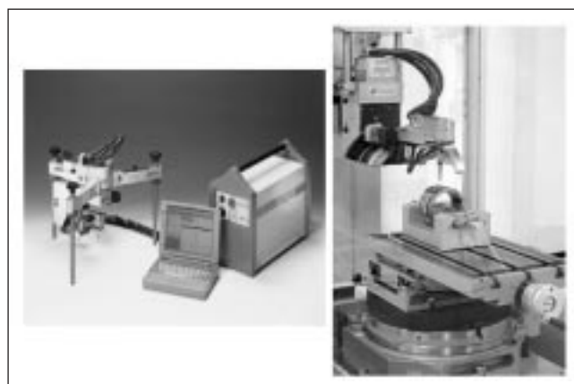
Fig. 4 – Diffrattometro a raggi X di piccole dimensioni [15]. Fig. 4 – X-ray diffractometer of reduced size [15].
