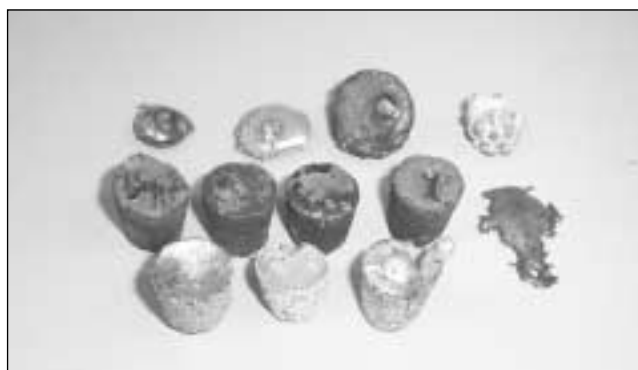
Fig. 2 – Lingotti ottenuti per MWaM di metalli diversi. Fig. 2 – Small ingots obtained by MWaM of different metals.
