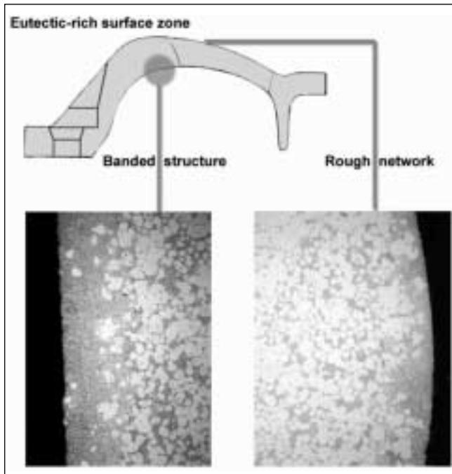
Fig. 6b – Thixoformed AlSiMg 0.6 T5 alloy disc.
