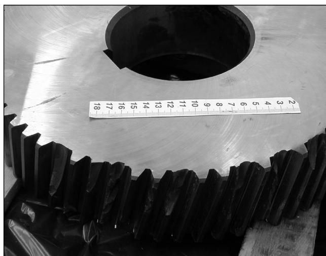
*Fig. 1 – Cedimento dopo poche ore di servizio su ruota dentata in acciaio non correttamente carbocementata. I prodotti industriali non sempre mostrano proprietà tribologiche adeguate per l'applicazione. Fatalità o mancanza di conoscenze? [Archivio CERMET].*
