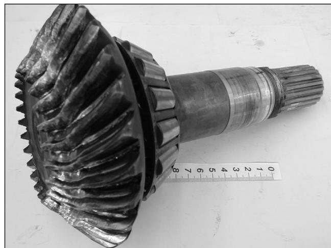
Fig. 5 - Deformazione e usura della dentatura di un pignone [Archivio CERMET].
