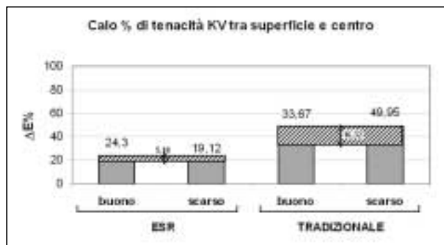
Fig. 12 – Calo % di tenacità a frattura KV tra superficie e cuore dei provini trattati
