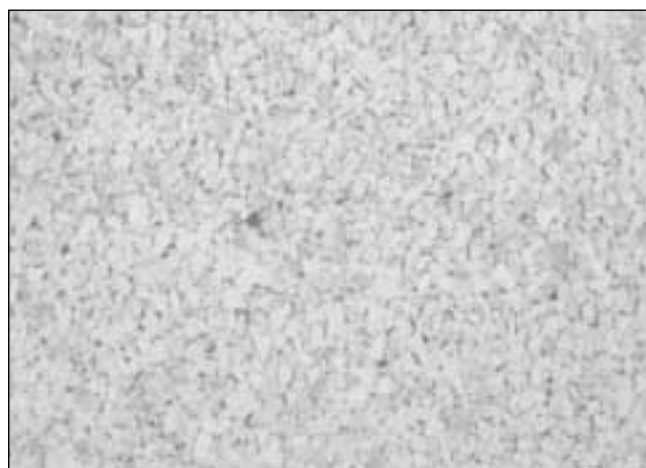
Fig. 3 – SAE1006 ricotto. Campione laminato al 67%, ricotto (200X), Nital 3% per 15s.
