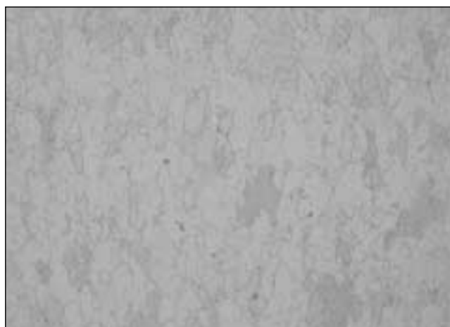
Fig. 4 – SAE1006 ricotto per 140h. Campione laminato al 67%, ricotto (100X), Nital 3% per 15s.
