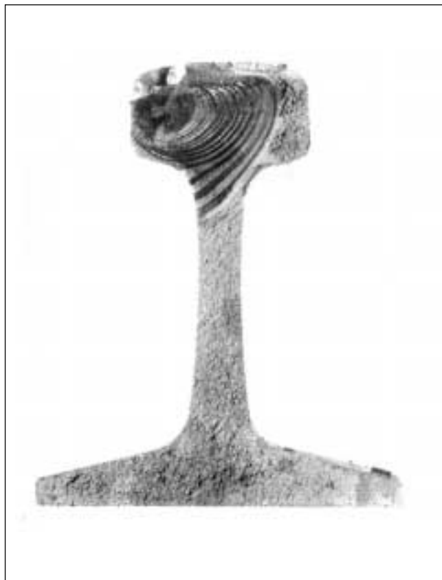
Fig. 7 – Rottura per fatica di un binario ferroviario; macrofrattografia della zona interessata dal danno; sono visibili ad occhio nudo le linee di spiaggia.
