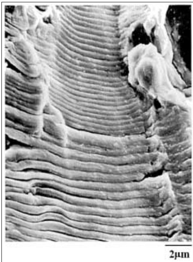
Fig. 6 – Particolare al SEM di microstriature prodotte durante l'avanzamento della cricca di fatica.
