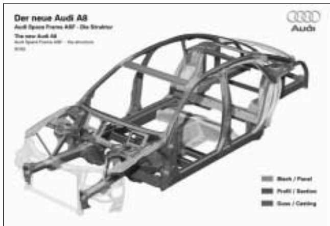
Fig. 4 - Struttura portante in Alluminio dell'autovettura Audi A8. Fig. 4 - Space frame in Aluminium for car Audi A8.
