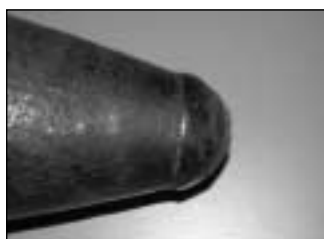
Fig. 2 – Effetto di un posizionamento non corretto della punta.
