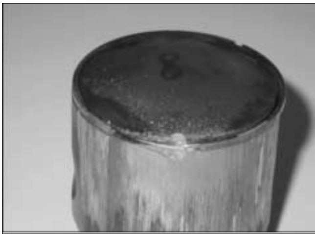
Figura 18: frattura segmento zona luce scarico
