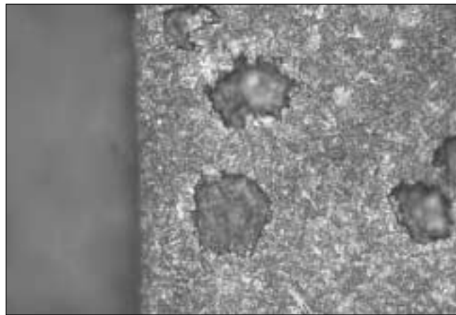
Fig. 8 – Strato Temprato ad induzione HRC = 59 – 500 X – Nital 2 %
